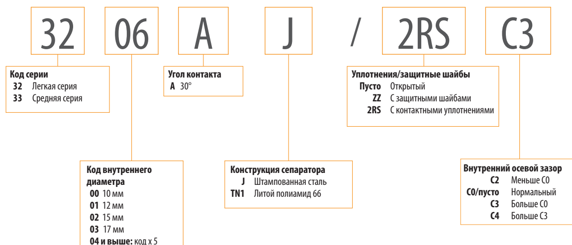
Рис. 18. Номенклатура двухрядных радиально-упорных шариковых подшипников.
