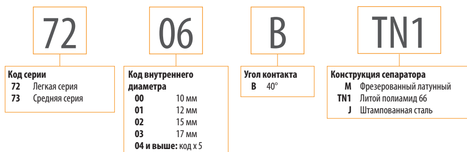
Рис. 15. Номенклатура однорядных радиально-упорных шариковых подшипников стандартной конструкции.
