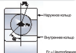
РУШП: Различие углов контакта при высокоскоростных операциях Осевая жесткость керамических радиально-упорных шариковых подшипников
