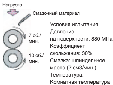
Испытание на износ 2 цилиндрических роликов
