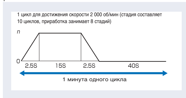
Рис. 2.4 Один цикл приработки в повторнократковременном режиме
