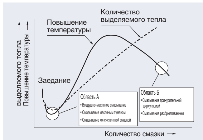
Рис. 6.1 Количество смазки и повышение температуры
