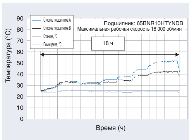
Рис. 2.1 Изменения температуры при работе с постоянной скоростью
