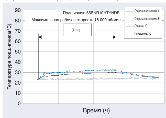
Рис. 2.3 Изменения температуры при выполнении приработки в повторнократковременном режиме
