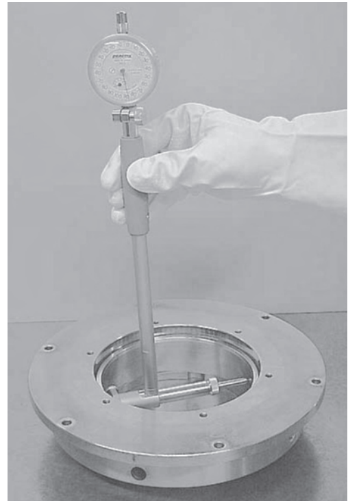
Рис. 1.11 Регулировка вписанного диаметра калибра GN
