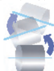
ЦРП: Перекос роликов при выполнении высокоскоростных операций
