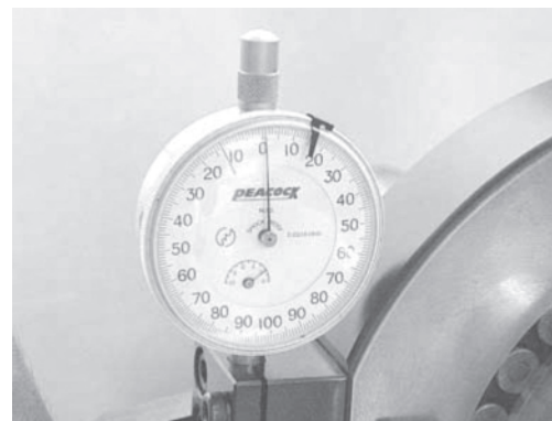
Рис. 1.15 Измерение ширины проставки
